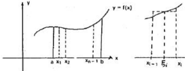
用點  $x_0, x_1, x_2, \dots, x_n$  將  $[a, b]$  分成  $n$  個子區間其中  $a = x_0 < x_1 < x_2 < \dots < x_{n-1} < x_n = b$ ，同時設  $x_i - x_{i-1}$  記為  $\Delta x_i$  及  $\xi_i$  為在  $[x_{i-1}, x_i]$  內任一點。由曲線  $y = f(x)$ 、直線  $x = a$  及  $x = b$
