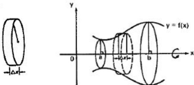
教師宜向學生強調圓盤元素體積  $\Delta V$  或  $dV$  的公式為  $dV = \pi y^2 dx$ , 它代表圓盤的體積。整個固體的體積為  $\pi \int_a^b y^2 dx$ 。教師更可向學生介紹曲線沿  $y$ -軸旋轉所形成的體積是  $\pi \int_c^d x^2 dy$ 。
